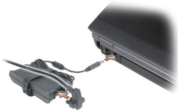
**⚠ PRÉCAUTION :** L'adaptateur secteur fonctionne avec les tensions secteur disponibles dans le monde entier. Cependant, les connecteurs et les rampes d'alimentation varient selon les pays. L'utilisation d'un câble non compatible ou le branchement incorrect du câble sur la rampe d'alimentation ou la prise secteur peut provoquer un incendie ou endommager l'équipement.
